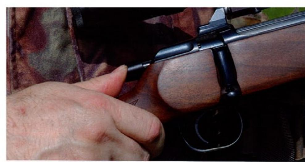
Bild links: Sicherheit durch Handspannung. Das Schloss lässt sich geräuscharm spannen und entspannen.
