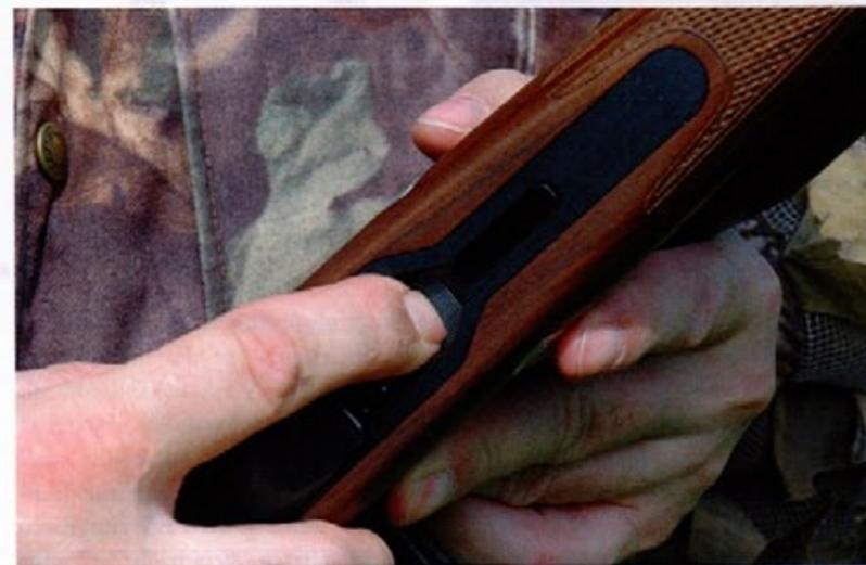
Bild links: Die Tirolerin ist einfach zerlegbar mittels Drucktaste.
